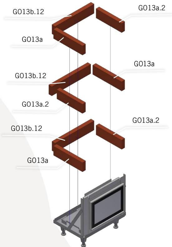
Setzen Sie zunächst die 1. Reihe der Mantelteile trocken auf die Fasermatten ins Grundgestell.
