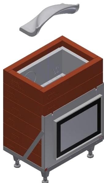
Positionieren Sie die Umlenplatte auf den GOS, und schieben Sie diese immer ganz nach hinten und zur Seite des Ausbrandes.
