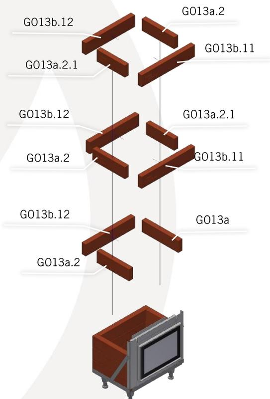
Bevor Sie mit den Mantelsteinen über die Tür mauern, ist diese mittels den seitlichen Klemmleisten winkeligerecht zur Bodenplatte auszurichten und festzuschrauben.
