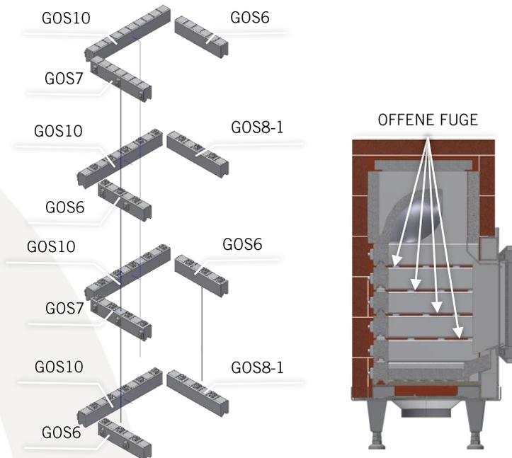
Setzen Sie nun die restlichen Reihen der GOS auf. Dabei muss in jeder Reihe umlaufend ein 6 mm Luftspalt zwischen den Steinen entstehen.
