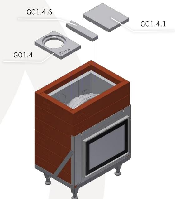
Positionieren Sie nun die Abdeckung der Nachbrennkammer.
